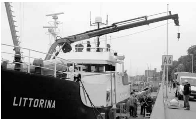
Der neue Kran der Littorina hebt nicht nur Bohrkerne, sondern hilft auch bei der Beladung des Kutters mit den Messgeräten. Foto Julia Zahlten, Copyright: CAU
