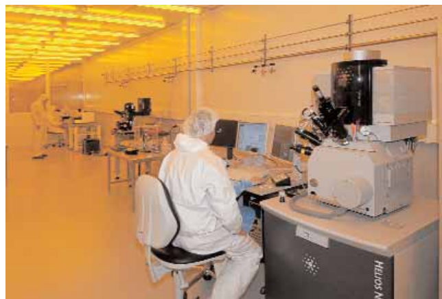
Im Reinraum des Nanolabors verhindert das gelbe Licht die ungewollte Belichtung von Fotolacken in der Fotolithografie. Im Vordergrund arbeitet ein Mitarbeiter an einer kombinierten Ionen-/Elektronenstrahlolithographieanlage. Copyright: CAU, Foto: Eckhard Quandt
